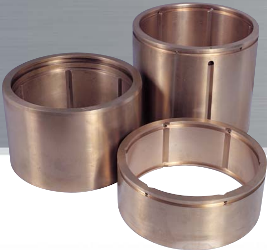
1 ITEM : MIDDLE BUSH DIM : O.D350 × I.D320 × B315 MAT'L : BRONZE L.F.D UPB8 N13 2 ITEM : UPPER BUSH DIM : O.D350 × I.D320 × B140 MAT'L : BRONZE L.F.D UPB8 N13 3 ITEM : LOWER BUSH DIM : O.D360 × I.D320 × B229 MAT'L : BRONZE L.F.D UPB8 N13
